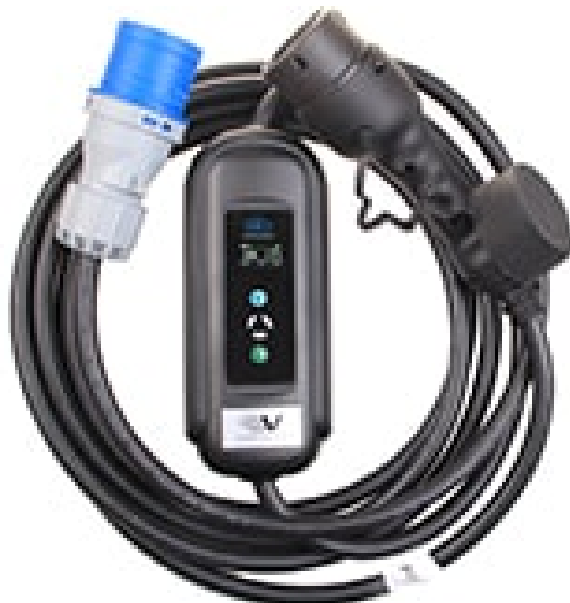
EV Ładowarka samochodów EVSE Type2 (max. 32A, 1 faza 7,4kW)
